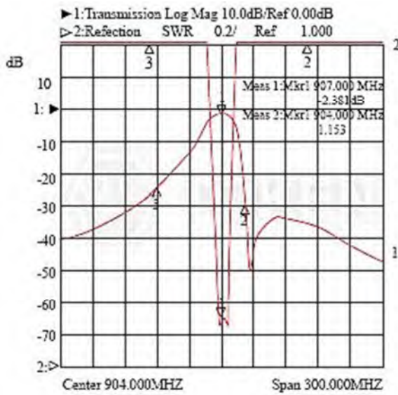
DF-B 系列 II - (Center 904.000MHz Span 300.000MHz) 波形特性
