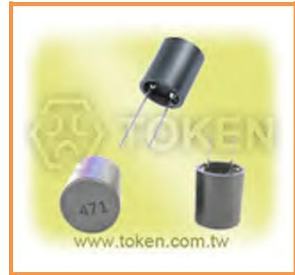
德铭特 (TCRCS) 系列阻流线圈规格齐全，具有质量因素好，自共振频率高，可获得较大的感应电流，漏磁小等优点。阻流线圈电感 (TCRCS) 采用开磁路构造设计，用 PVC 或 UL 热缩套管保护，有立式和卧式结构，有结构性佳、体积小、高 Q 值、低成本等特点，适用于笔记本电脑、喷墨打印机、复印机、显示监视器、手机、宽带调制解调器、游戏机、彩色电视、录放机、摄影机、微波炉、照明设备、汽车电子产品等。
